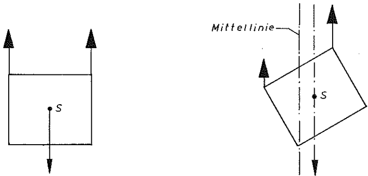
Bild 2. Schwerpunktverlagerung bei ungleichen Hub- oder Senkbewegungen
