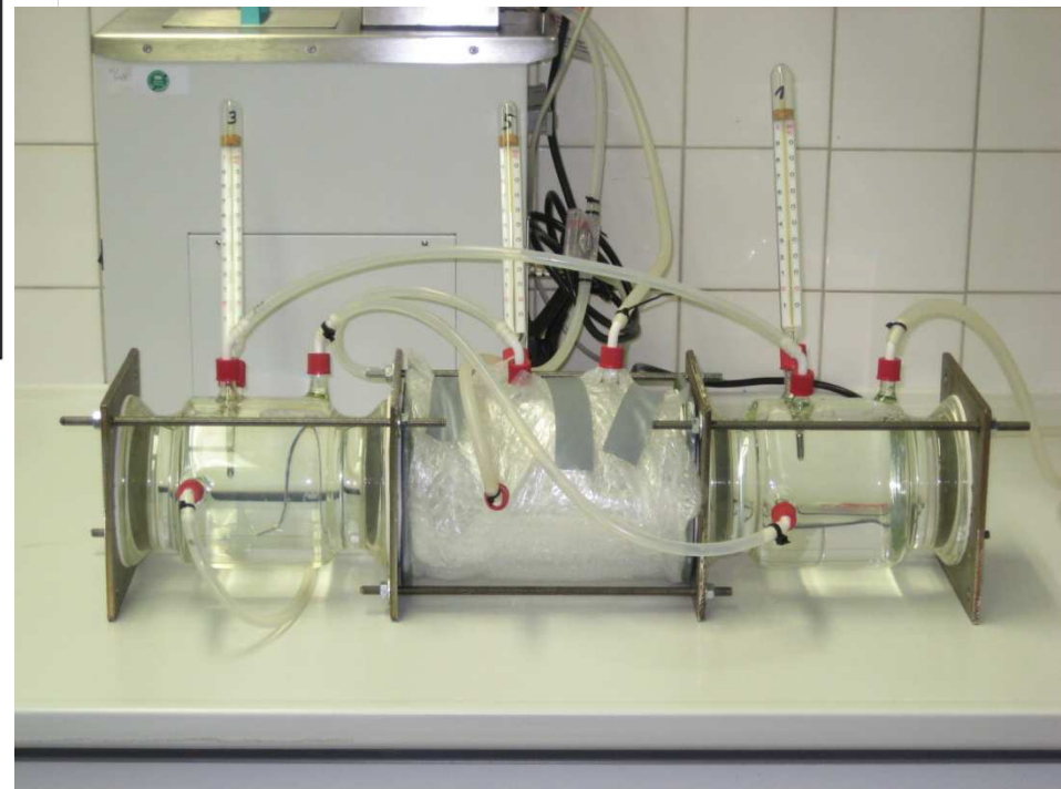
Foto 9 und 10 - Skizze und Aufbau \Delta T -Test - Atlas-Zellen-Test "W"
