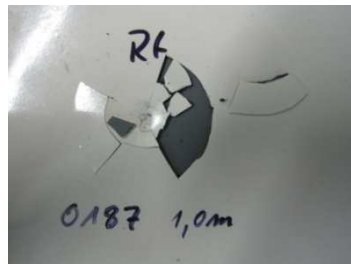
1,00 m - Raumtemp. Abplatzungen
