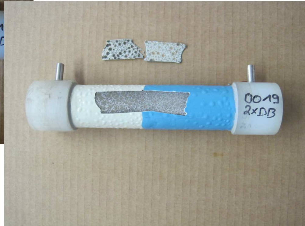
Foto 13 und 14 - Blasenbildung und "Beitelprobe"
