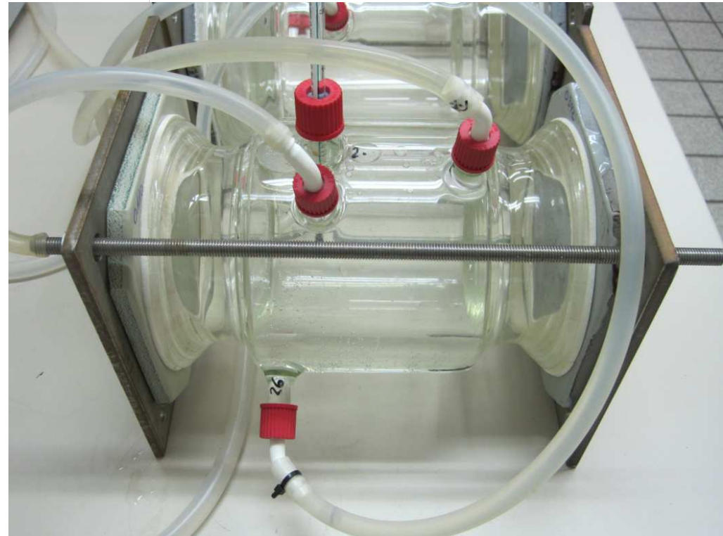
Foto 11 und 12 - Skizze und Aufbau \Delta T -Test - Atlas-Zellen-Test "L"
