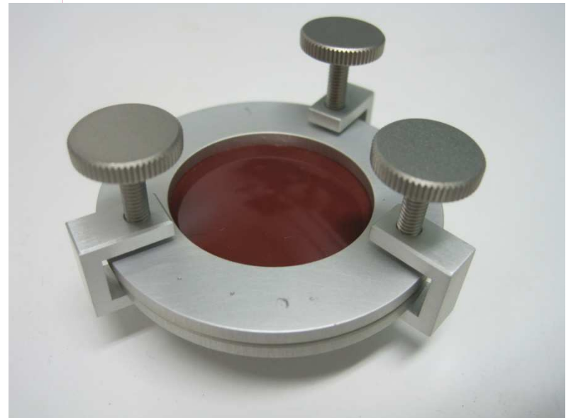
Foto 5 und 6 - Skizze und Topf Wasserdampfdiffusion
