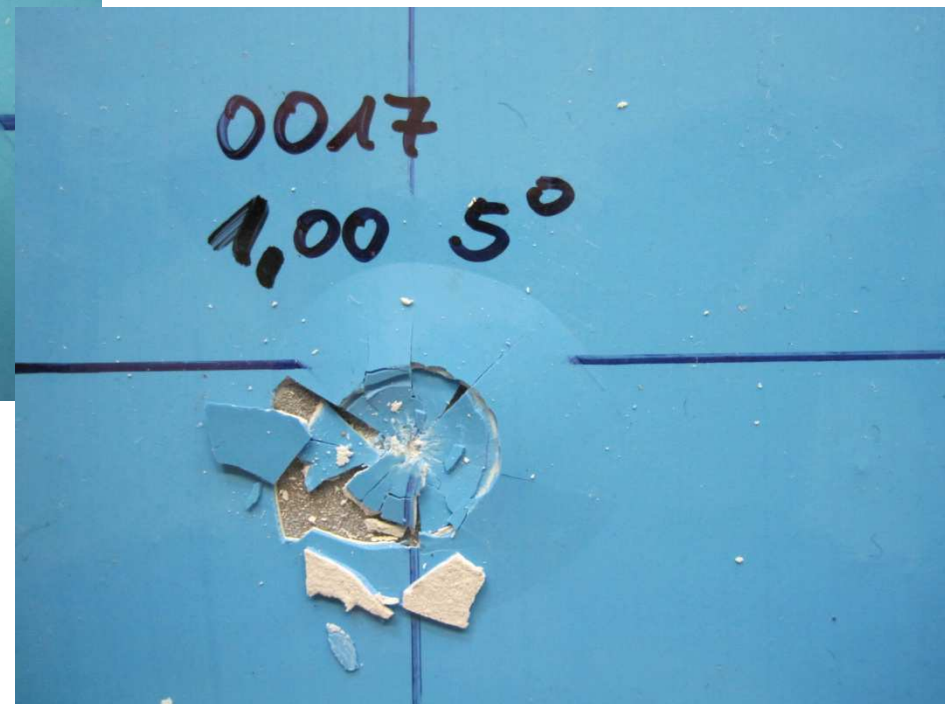
Foto 3 und 4 - Schlagfestigkeit - warme und kalte Umgebung
