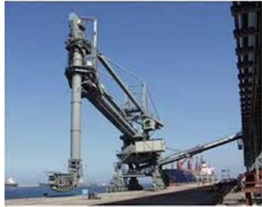
Bild E 223-8: Verfahrbare Löschbrücken (links), Lumut (Malaysia) [BAM International] und Eimerketten-Entlader (rechts) [FLSmidth]
