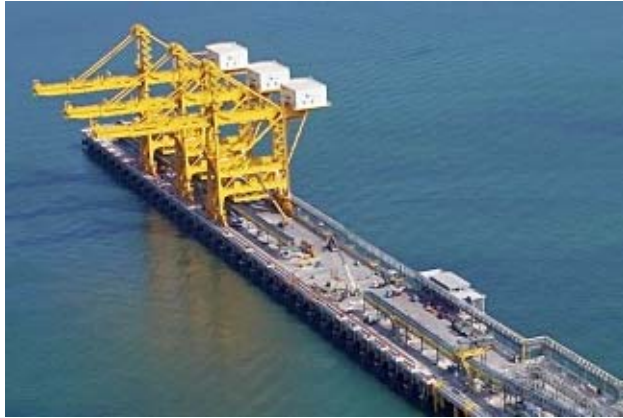
Bild E 223-8: Verfahrbare Löschbrücken (links), Lumut (Malaysia) [BAM International] und Eimerketten-Entlader (rechts) [FLSmidth]
